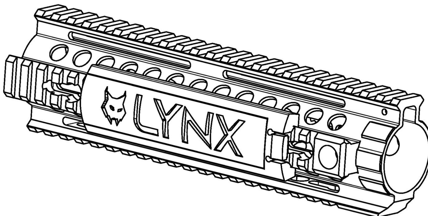
DEBIDO A LAS DIFERENTES MARCAS, MODELOS Y TOLERANCIAS, ALGUNOS RIELES PICATINNY PUEDEN HACER QUE EL LTT SE AJUSTE DEMASIADO APRETADO O UN POCO SUELTO. SI ES DEMASIADO APRETADO, LIJAR LIGERAMENTE EL LTT DENTRO DEL RECEPTOR DE CARRIL PICATINNY. SI ES UN POCO LARGO, USA UN PEQUEÑO TROZO DE CINTA ADHESIVA EN EL PICATINNY PARA ENCAJAR.
